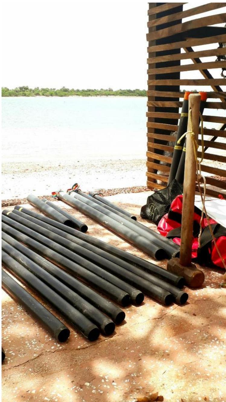
Figure 38 : Tuyaux en PVC utilisés pour collecter les sédiments à Unhocomozinho, Guinée-Bissau, août 2022.
