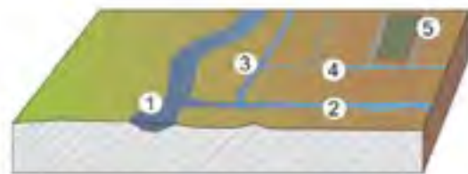
Fig. 11.6. Esquisse du système d'irrigation; 1= distributeur, 2= partiteur, 3= arroseurs, 4= rigoles, 5= division des parcelles en bassins.
