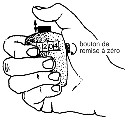
Figure 6.2. Compteur manuel utilisé pour compter le plus correctement possible des nombres d'oiseaux ou de nids dans les colonies
